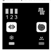
Indica que ha intervenido el presostato para desactivar el compresor. Para el restablecimiento de este dispositivo deben realizarse las siguientes operaciones:
